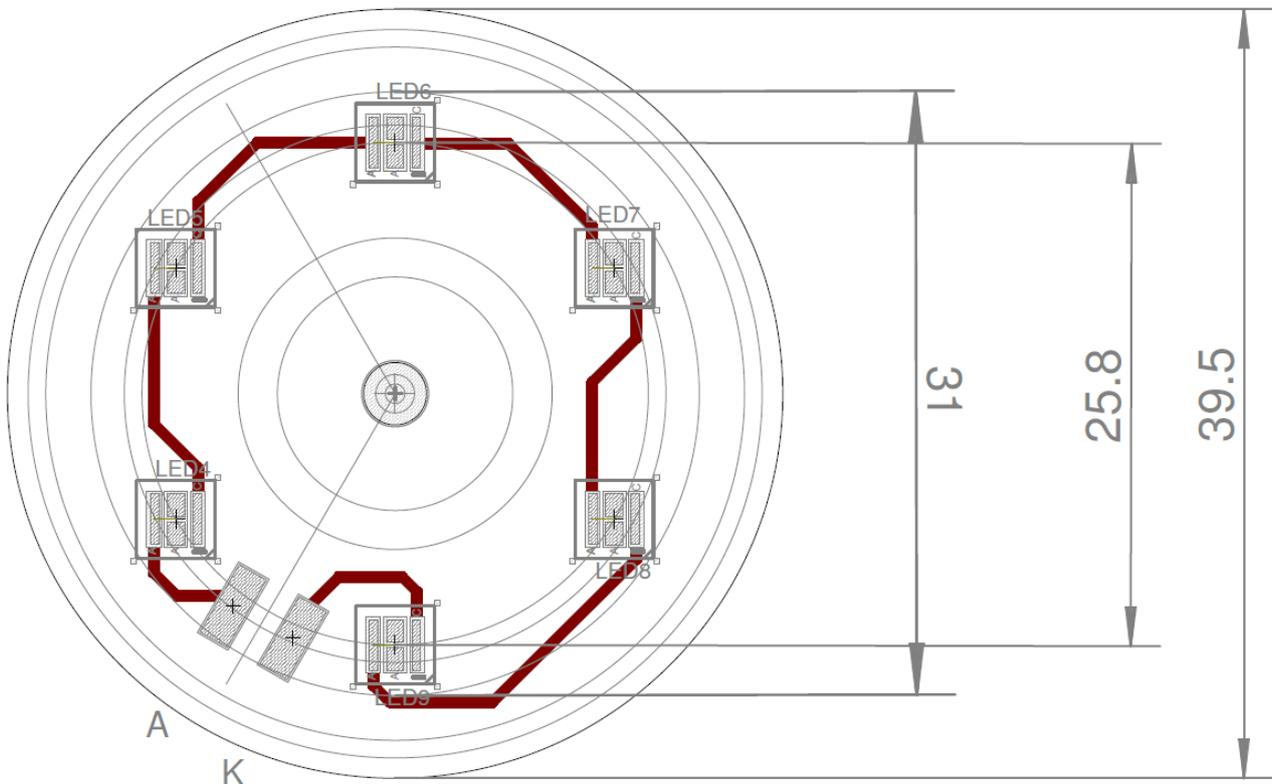
Abmessungen der LED-Platine, Dicke Substrat: 1.6mm.
