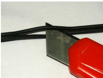
1) Trennen der beiden Adern mit scharfem Messer
