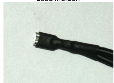
6) Schrumpfen mit LötKolben oder Föhn
