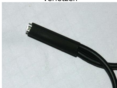
5) Schrumpfschlauch über den Stecker schieben
