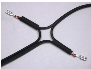
4) Schrumpfschlauch aufschieben und Stecker anlöten
