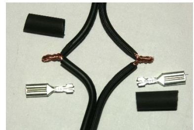
3) Verdrehen der Kupferadern Schrumpfschlauch auf 15-20mm zuschneiden
